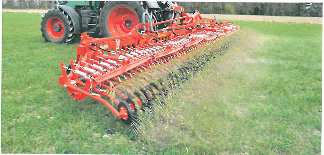
Tænderne på Aerostar Rotation er monteret på en roterende disk, der er skråtstillet, så de aggressive tænder renser inde i rækken. Tændernes aggressivitet kan reguleres hydraulisk fra traktoren til varierende forhold med jordtyper og afgrødestadie. Foto: Kaj Lund Sørensen
